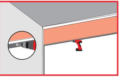
Após ajustar o comprimento da peça, utilize uma furadeira para fazer o furo que será colocado a buxa e o parafuso de fixação do REVID SLIM.
