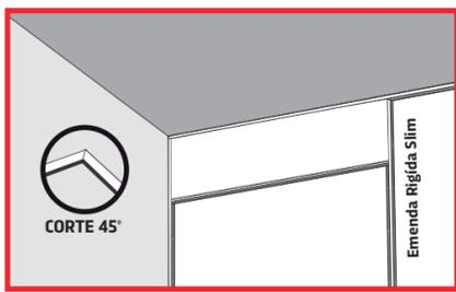
Para a instalação do Acabamento Convencional SLIM, nos cantos faça um corte diagonal (meio esquadro, 45°) para obter o encaixe. Caso seja necessário a instalação de emenda, a Emenda Rígida SLIM deve ser previamente instalada no local correto.
