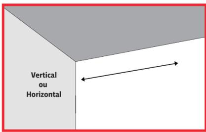
Defina o sentido em que o REVID SLIM será instalado. Marque a altura em relação ao chão em que o REVID SLIM será instalado. A marcação deve ser feita em todos os cantos das paredes e, depois, marque em todas as paredes no mesmo nível.
