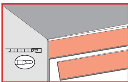
Com o REVID SLIM ajustado, encaixe os perfis no Acabamento Convencional SLIM. O encaixe macho deve ficar voltado para o fundo do acabamento, dando sequência na instalação sempre encaixando o encaixe macho no encaixe fêmea.
