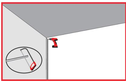
Ajuste o comprimento do Acabamento Convencional SLIM em relação a parede e fixe o mesmo em toda sua extensão diretamente na parede.
