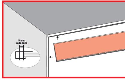
Deixe uma folga de 5mm entre o REVID SLIM e a extremidade do acabamento de ambos os lados, para evitar ondulações devido a dilatação do revestimento.
