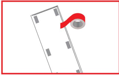
Após ajustar o comprimento da peça, aplique alguns pedaços da fita dupla face no verso. Procure aplicar nas duas extremidades e a cada 30cm para melhor fixação na parede.
