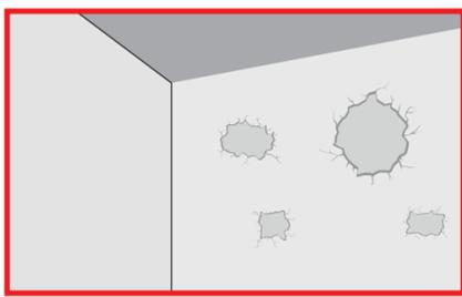
Para paredes com imperfeições ou irregulares, é indicado a instalação do Tubete de PVC como estrutura de fixação do REVID SLIM.
