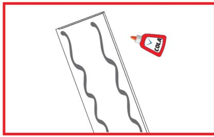
Após ajustar o comprimento da peça, aplique a cola no verso, sempre aplicando de uma extremidade a outra como demonstrado na imagem.
